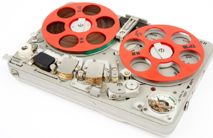
Das Mini-Nagra, auch Nagra SN genannt, war das kleinste professionelle Tonbandgerät und wurde nicht nur von Produzenten, sondern auch von Geheimdiensten geschätzt. Foto: PD
