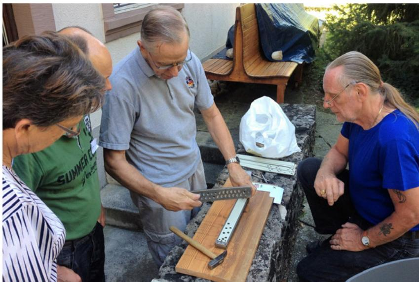
Schlagen einer neuen Lochkarte. Die Lochkarte steuert über die Schaftmaschine, welche Schäfte gehoben werden. Dadurch entstehen die Webmuster.
